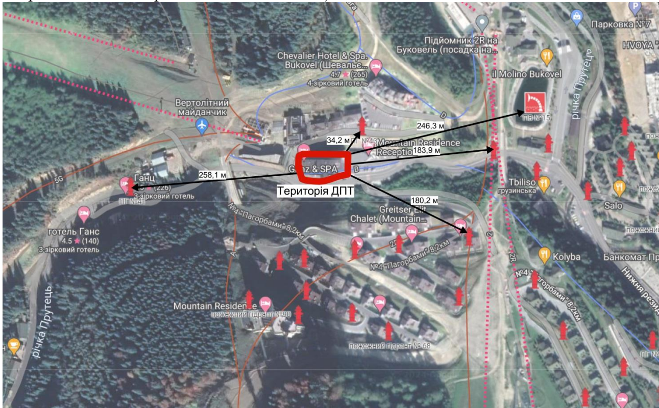
Рисунок 6.1 - Схема пожежного водопостачання в с. Поляниця (відповідно до даних карти «Протипожежне водопостачання ГУ ДСНС України в Івано-Франківській області»)
